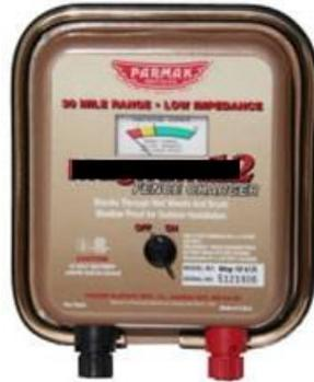
圖二：( 直流電 ) 電牧器(輸入電源：DC12V(汽車電瓶)；有效長度 50 公里；輸出電壓：9.5KV；輸出功率：1.5 焦耳；使用注意事項：(1)須安裝接地線(避免雷擊損毀)；(2)接電時應做好導線絕緣措施；(3)使用電壓檢測器量測電瓶電壓；(4)不可直接置於戶外任風吹雨淋；(5)農地較不適合使用太陽能型電牧器；(6)要經常巡查有無異物在電牧導線上避免漏電。)
